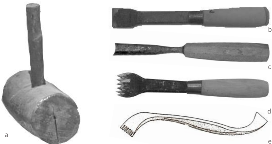
Maillet (a), ciseau (b), gouge (c), gradine (d) et ripe (e).
